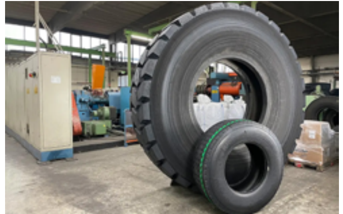
Runderneuerte Markenreifen für Pkw und Nutzfahrzeuge werden mittlerweile in allen erforderlichen Größen und Dimensionen angeboten. Die Reifendurchmesser reichen von 13 bis 30 Zoll. Foto: © Rigdon
