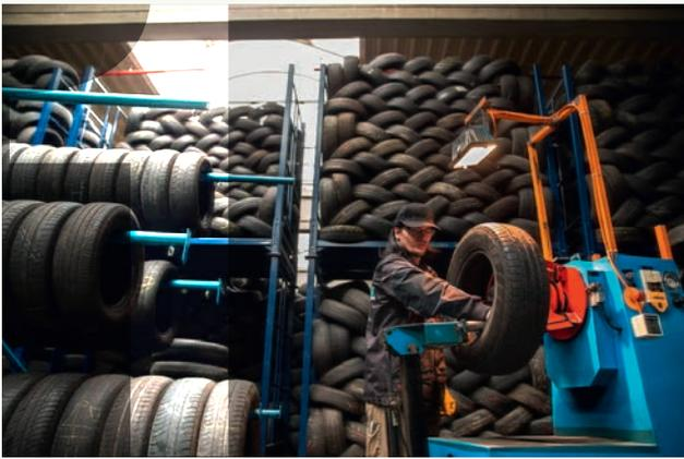
**Eingangsprüfung:** Bevor eine Karkasse zur Werks-erneuerung zugelassen wird, muss sie die Eingangs-prüfung überstehen – hier werden die bereits optisch vorsortierten Reifen geprüft. Mittels Shearografie, einer Lasertechnologie werden die Karkassen durchleuchtet und vorbeschädigte Reifen aussortiert. Nur rund 30 % aller anfallenden Altreifen können für die Runderneuerung eingesetzt werden.
