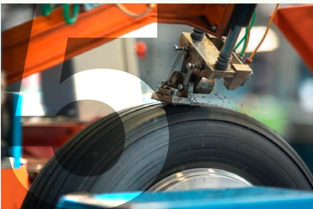
**Finale Qualitätskontrolle:** Im Rahmen der Endkontrolle wird auf halbautomatischen Entgratmaschinen überschüssiges Gummimaterial entfernt. Außerdem finden Rundlauf- und Druckprüfungen statt.
