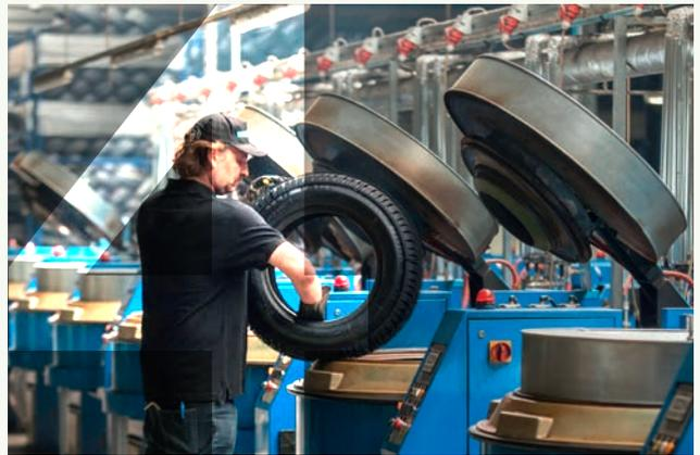
**Heizen:** Die Reifenrohlinge werden der jeweils richtigen Heizpresse zugeführt. Unter einem Druck von rund 15 bar und bei einer Temperatur von 160 °C bekommt der Reifen sein neues Profil und das zuvor aufgebrachte Gummi geht vom plastischen in den elastischen Zustand über. Dieser Arbeitsschritt ist identisch mit dem der Neureifenindustrie.
